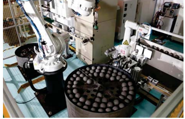
चीन में शिदाओवान उच्च ताप गैस-कूल्ड रिएक्टर पेबल-बेड मॉड्यूल में ईंधन लोडिंग अप्रैल 2021 में शुरू हुई, जिसमें दो छोटे रिएक्टरों में 870,000 गोलाकार ट्राइसो ईंधन तत्व शामिल थे जो एक 210 डैम टर्बाइन को चलाएंगे। स्रोत: चाइना नेशनल न्यूक्लियर कार्पोरेशन ( सीएनएनसी )।
